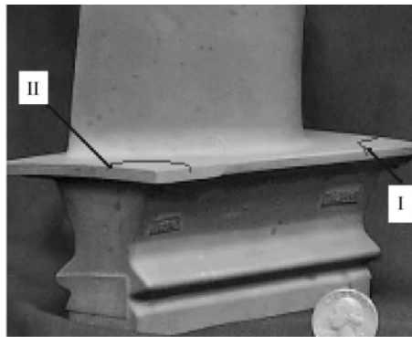
图1 叶片缘板裂纹部位
